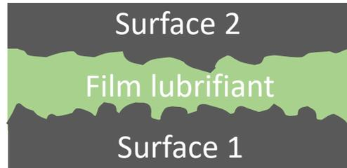
Le lubrifiant empêche le contact entre les surfaces frottantes
