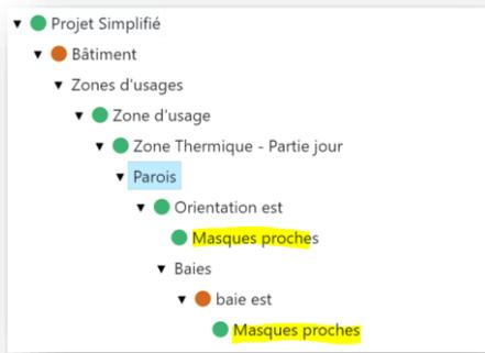
Les nœuds masques proches apparaissent sur chaque nœud *Nouvelle baie* ou *Nouvelle paroi verticale* créé.
