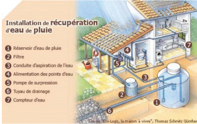
Illustration 4.15 : Système de récupération des eaux de pluie intégré
